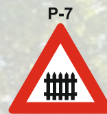
Paso a nivel con barrera
